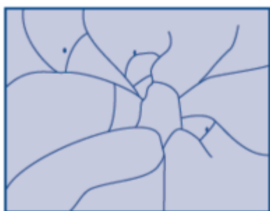
Rys. 53 Uderzenie w powierzchnię szkła (np. rzut kamieniem)
