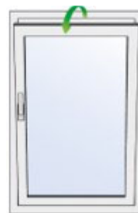
Samo uchylene skrzydła, może być rozwiązaniem niedostatecznym
