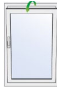
Samo uchylene skrzydła, może być rozwiązaniem niedostatecznym
