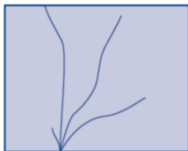
Rys. 57 Nacisk na krawędź
