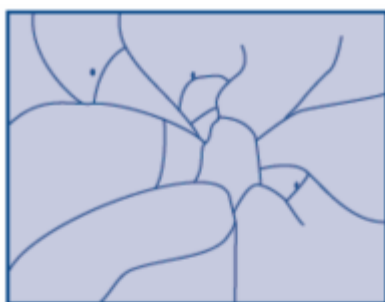
Rys. 53 Uderzenie w powierzchnię szkła (np. rzut kamieniem)
