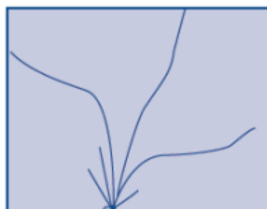
Rys. 55 Uderzenie w krawędź
